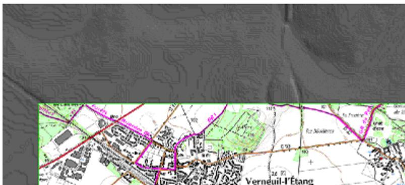
fig. 22) Illustration d'un ombrage généré sur MNT IGN 25 m qui montre les sauts de valeurs dont la trace correspond parfaitement aux courbes de niveau du SCAN25.
